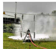
Figuur 3.5 Meting van lekstromen bij sproeiblussen met schuim (Sepanski et al., 2015)
